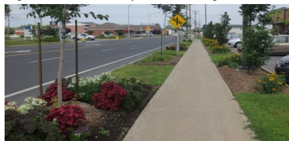
Figure 1. Bordure de protection végétalisée
