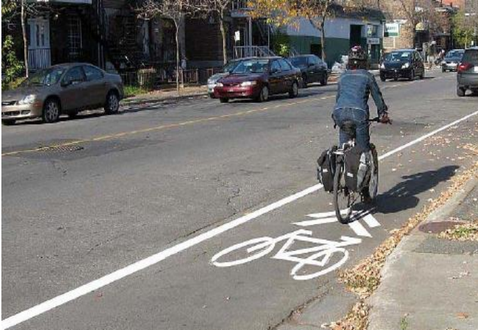
Figure 6. Bande cyclable unidirectionnelle de chaque côté de la rue (avec ou sans délinéateurs)
