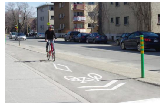
Figure 10. Piste cyclable unidirectionnelle surélevée et séparée par bordure
