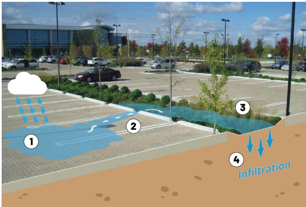
Figure 13. Bande végétalisée transformée en noue plantée d'infiltration
