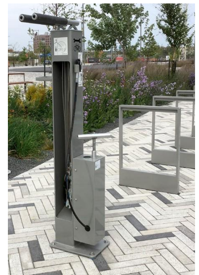
Figure 8. Station de réparation libre-service de vélos
