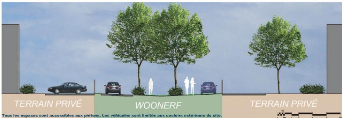
Figure 24 : Vue transversale de l'aménagement du woonerf Saint-Pierre
