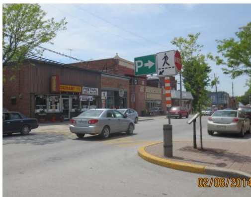
Figure 17 : Avancées de trottoir à un passage piétonnier, Bedford
