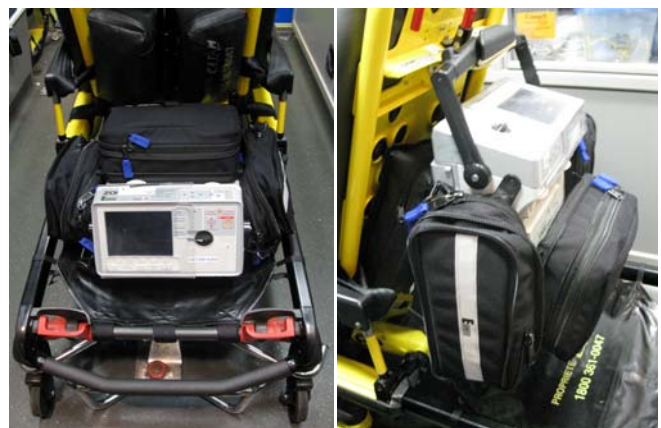
Installation du MDSA de façon non sécuritaire en cas d'impact du véhicule ambulancier et hasardeuse pour la surveillance clinique du patient. Cette façon de faire ne permet pas de voir l'écran et d'entendre les alarmes sonores du MDSA. De plus, l'accès au MDSA est compliqué.
